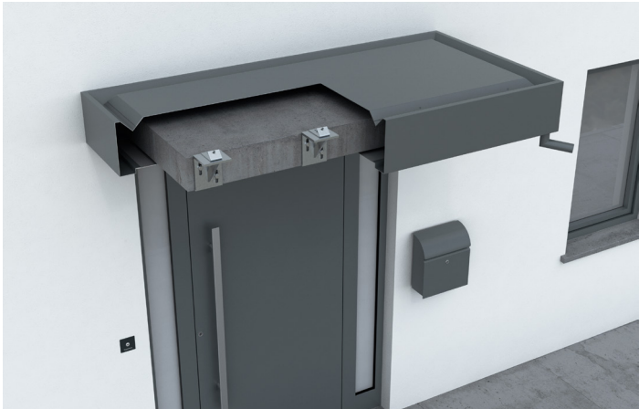
Au choix, comme habillage, par ex. type auvent KV 380 Dans ce cas, le cache de raccordement au mur est découpé dans la taille correspondante de l’avancée en béton existant et on y installe l’auvent en le glissant par dessus.
